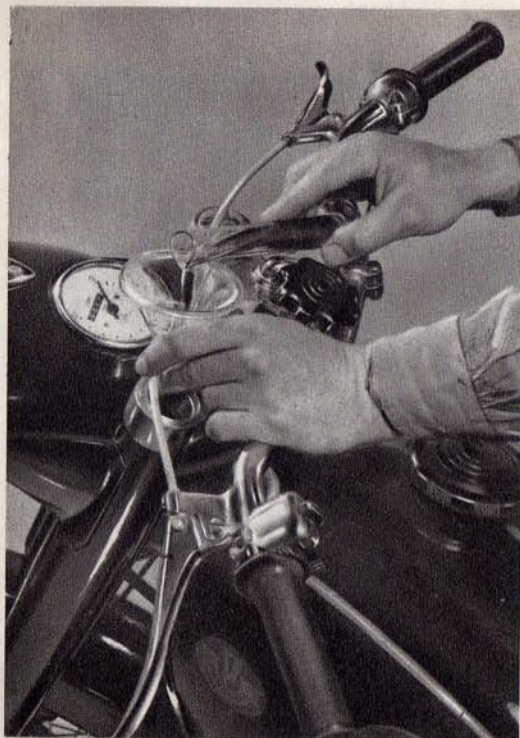
Abb. 60. Öleinfüllung in die Teleskopgabel
