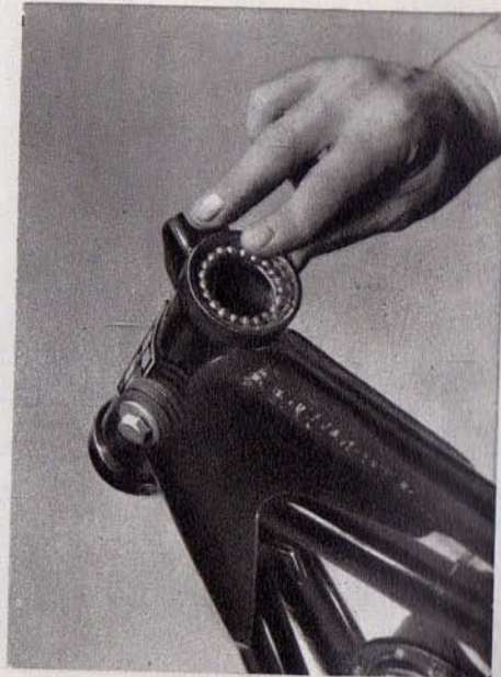
Abb. 61. Schmierung des Lenkungs-lagers
